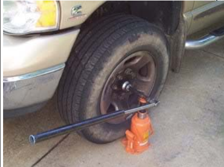
break lug nuts loose
